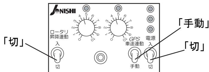
⑤ 電源を「入」にすると同時に散布を開始して時計で1分間はかります。1分経過と同時に電源を「切」にして散布を止めます。このとき、トラクタのエンジンをかけて作業時のエンジン回転数にしてください。そうしないと電圧が変化する場合があります散布精度に影響します。また、肥料が落下していることを確認してください。
