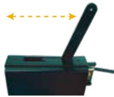
トラクタに乗ったまま、レバーを動かすだけで散布操作が行えます。
